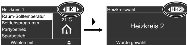
Die Heizkreise sind werkseitig mit „**Heizkreis 1**“ (HK1), „**Heizkreis 2**“ (HK2) und „**Heizkreis 3**“ (HK3) bezeichnet.
